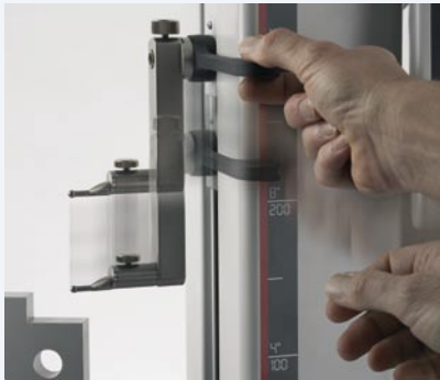
Bild 1. Messschlitten mit Hand in Richtung Messobjekt bewegen.
